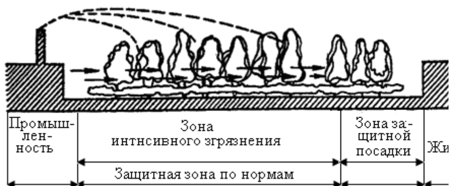
Рис. 1.5. Совмещенная схема движения загрязненных нижнего и верхнего потоков
